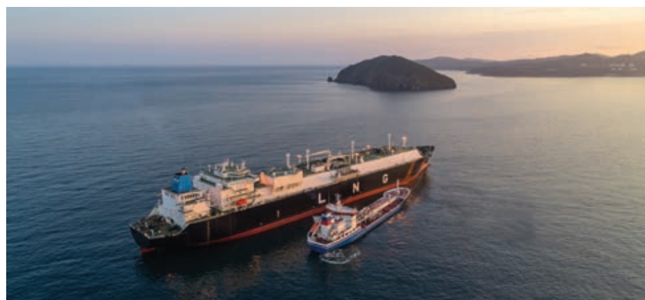
LNG vessel bunkering
