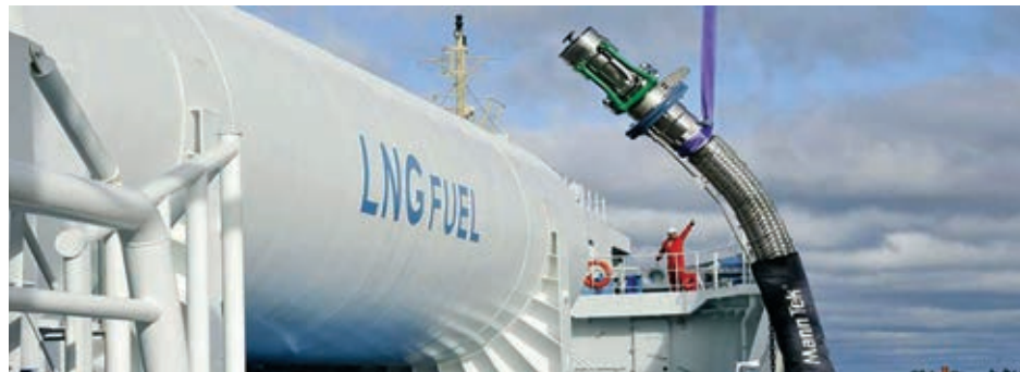
LNG bunker tank
