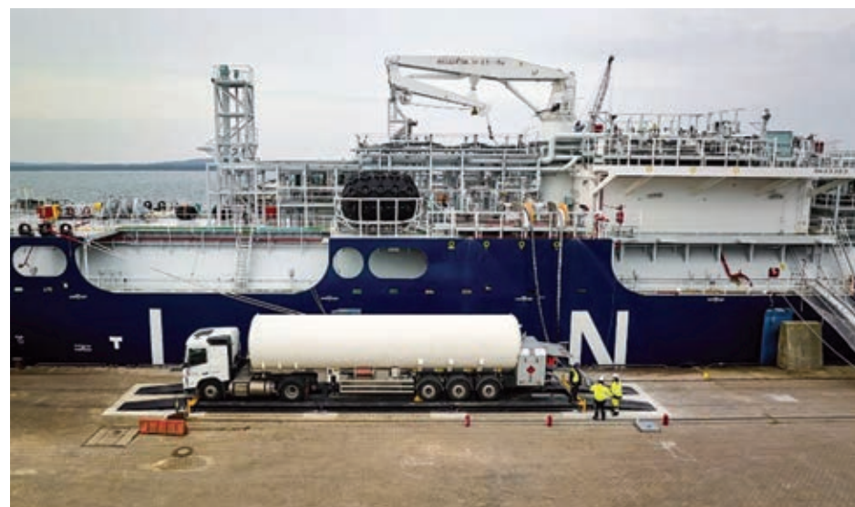
Avenir LNG truck unloading operation
