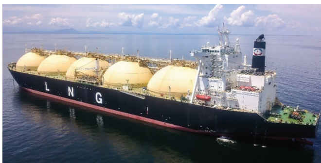
LNG carrier ISH, converted to an FSU
