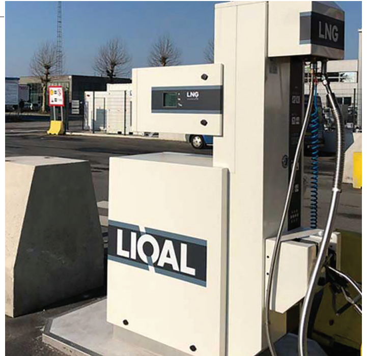
Liqal LNG dispenser
