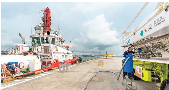
Truck-to-Ship LNG bunkering
