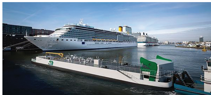
Titan LNG's bunkering pontoon
