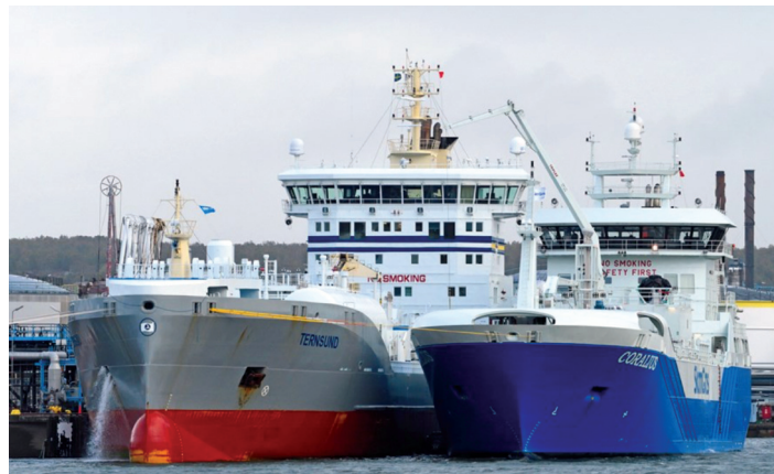
LNG bunkering vessel Coralius bunkering Ternsund last month
