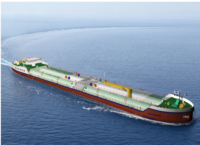
LNG bunkering barge
