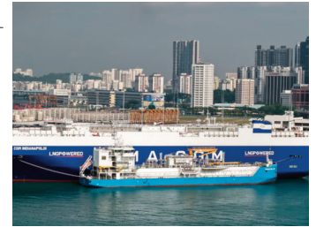
FueLNG Bellina conducting LNG bunkering
