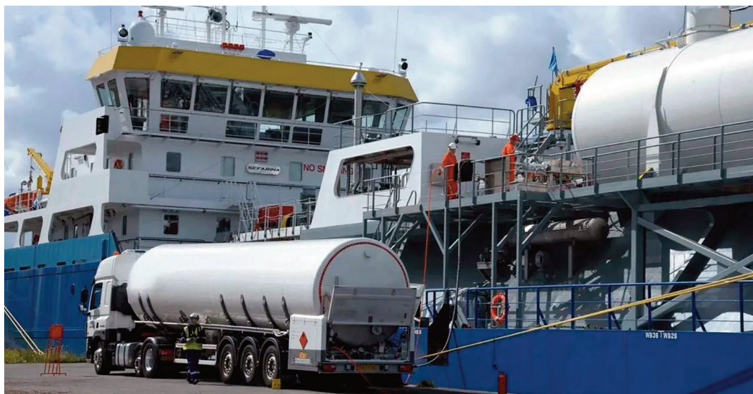
Truck-to-Ship LNG refuelling
