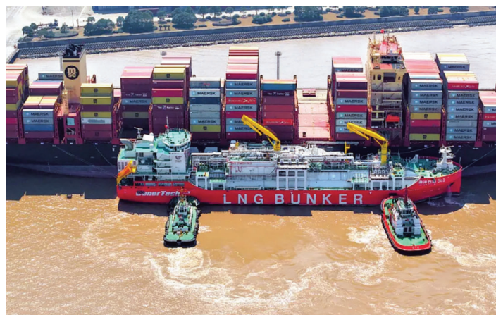
STS LNG refuelling
