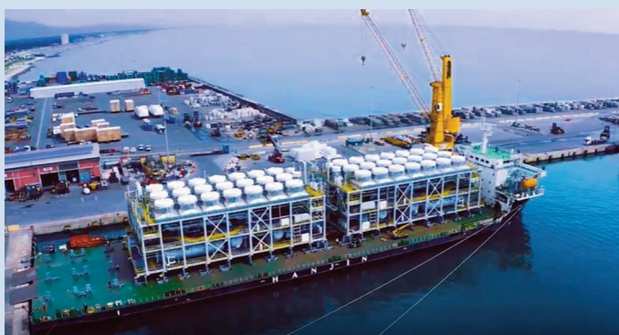
First liquefaction modules arrive for Plaquemines LNG
