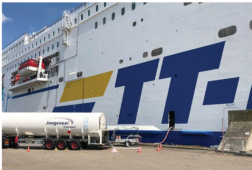
TT Line ferry bunkering with LNG
