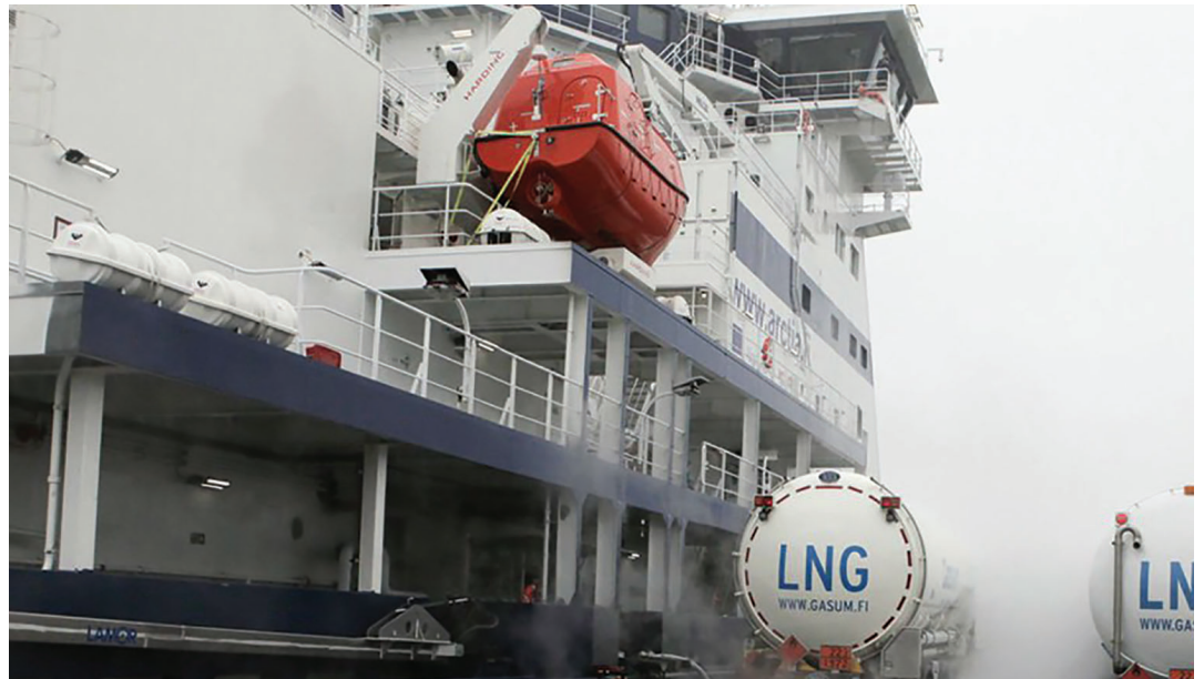
LNG refuelling operation
